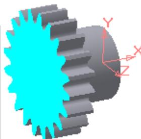
15. И последнее, необходимо вырезать отверстие для вала. Выберите команду **Внутренняя цилиндрическая ступень**, укажите торцевую плоскость ступицы, задайте параметры отверстия, завершите построение.
