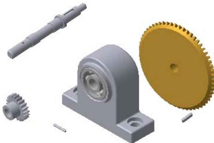
5. Теперь задайте положения вала. Назначьте сопряжения **Соосность** поверхности вала и отверстия в подшипнике и **Совпадение** торцевой поверхности цилиндрического пояска вала и внутреннего кольца второго подшипника.
