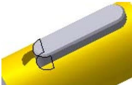
7. В дальнейшем, при построении выреза четверти, нам понадобится параллельность торцевой плоскости шпонки с горизонтальной плоскостью
