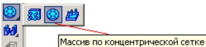
2. На панели свойств щелкните левой кнопкой мыши на кнопке **Ось** и укажите, также щелчком мыши, коническую поверхность зубчатого венца или ступицы, в результате программа выберет ось массива, совпадающей с осью тела вращения. Задайте количество элементов массива (в нашем примере – 58).
