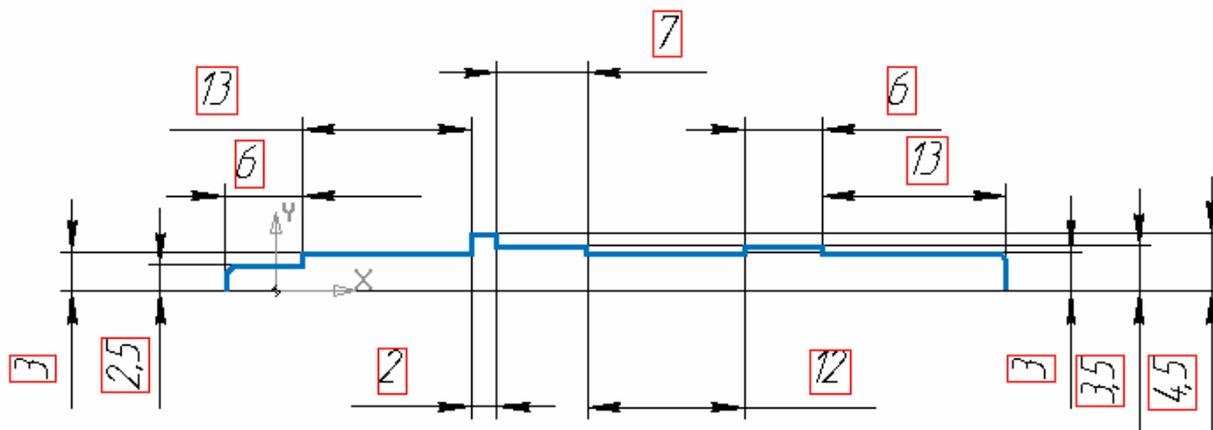
3. Используя команду **Операция вращения**, поверните эскиз вокруг оси. Тонкую стенку не создавайте. Для этого выберите на панели свойств: на вкладке «**Параметры**» способ создания – «**Сфероид**» и на вкладке «**Тонкая стенка**» выберите – **Нет**.
