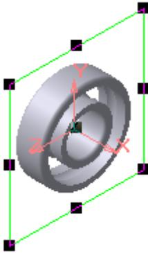
8. Постройте отрезок стилем линии – **Основная** от начала координат, длиной равной измеренному радиусу, для чего введите значение в соответствующее поле **Длина** панели свойств, нажмите клавишу **Enter** для фиксации этого значения и создайте объект.
