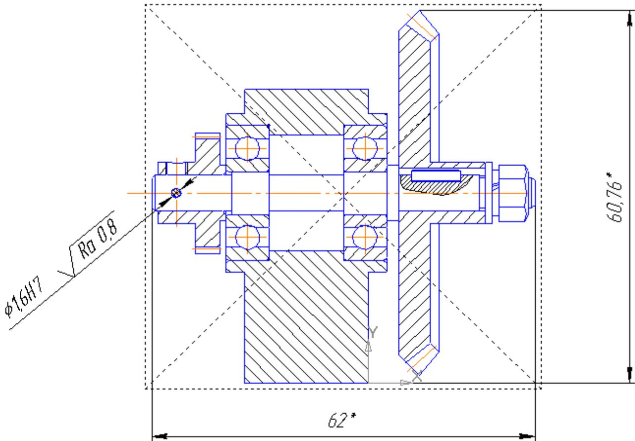
15. На виде слева для нанесения справочных присоединительных размеров отверстий выполните местный разрез через присоединительное отверстие в корпусе.
