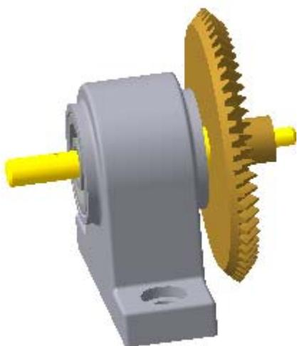
9. Установите на валу цилиндрическое зубчатое колесо. Наложите на колесо сопряжения **Соосность** посадочного отверстия колеса и вала, а также **Соосность** отверстия под штифт в ступице колеса и на валу.
