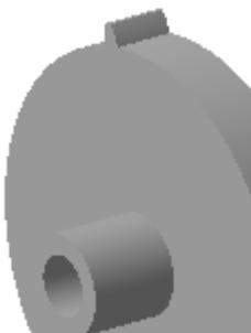
3. Выделите зуб в дереве построения, если выделение снято, выберите команду построения **Массива по концентрической сетке**
