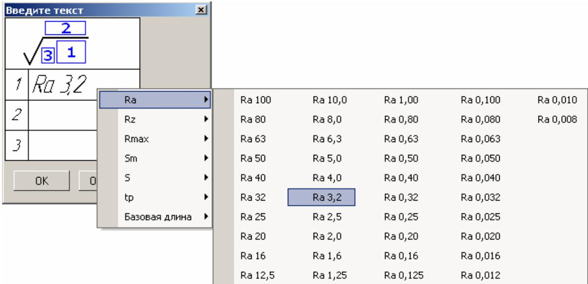
4. Для размещения знака на полке-выноске выберите вкладку **Параметры**, в списке **Полка** нужный вариант, укажите начало выноски и положение полки.
