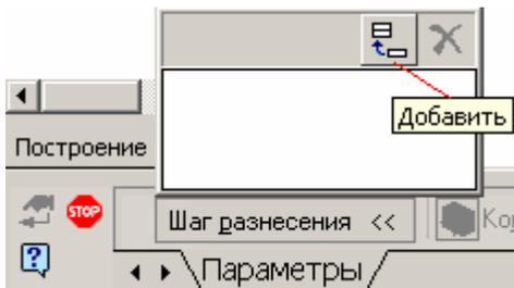
2. Нажав на кнопку **Компоненты**, выберите в дереве построения те компоненты, которые хотите вынести за один шаг. Нажав на кнопке **Объект**, задайте направление выноса, указав на ребро основания корпуса, направленного, например, вдоль оси вращения вала. Выберите направление прямое или обратное и задайте расстояние, после чего нажмите кнопку **Применить**.
