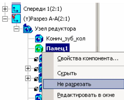
В результате у вас должны быть не разрезанными Вал, Штифт, Шпонка, у Подшипников – шарики, попавшие в секущую плоскость. После этого перестройте чертеж, нажав на кнопку **Перестроить**
