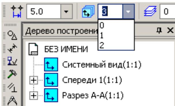
9. В учебных целях, на виде слева создадим местный разрез для показа профиля крепежных отверстий. Для этого выберите вид слева текущим (номер 1). Создайте замкнутую линию (например, кривую Безье) в нужной области разреза:
