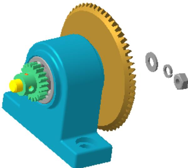
17. Осталось задать сопряжения **Соосность**, а также **Совпадение** соответствующих торцевых поверхностей.
