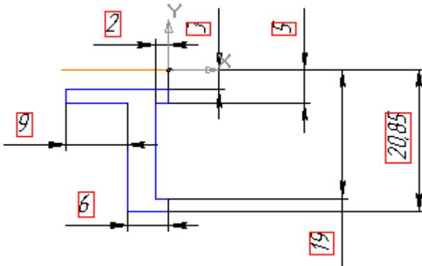
В нашем примере ось вращения смещена относительно контура будущего колеса, в результате при вращении контура будет образовано и посадочное отверстие.
