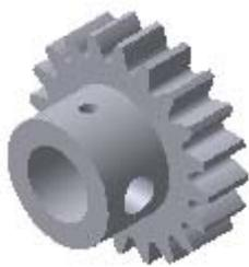
24. В таком виде зубчатое колесо понадобится для построения чертежа по модели. А для построения в дальнейшем сборки, используя команду **Исключить из расчета**, отключите построение направляющего отверстия, и **Включите в расчет** построение сквозного отверстия под штифт.
