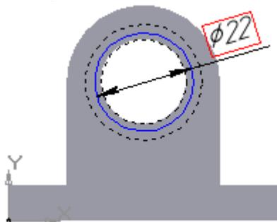
11. Вырежьте выдавливанием на глубину 7 мм.
