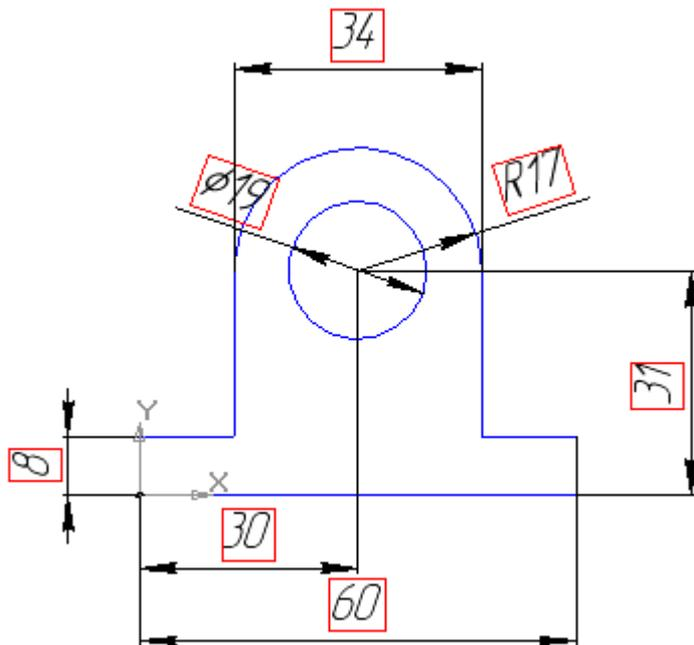
2. Выдавите этот эскиз на 20 мм. Заметим, что вложенный контур (на эскизе – окружность) создает при выдавливании отверстие заданного профиля и размера.
