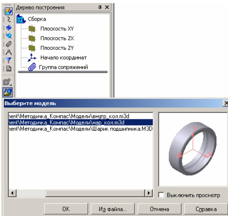
2. Укажите положение базовой точки модели в начале координат. В дереве построения рядом с названием деталь появится в скобках буква (ф), что означает модель – фиксирована.
