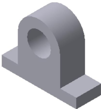
3. Выберите переднюю торцевую поверхность корпуса, при этом курсор будет в виде крестика со значком поверхности  $\perp$ , и постройте на ней следующий эскиз в виде окружности диаметром 26:
