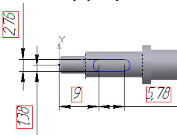
Попробуйте изменить значение ширины паза. В результате меняется положение верхней стороны. Для того чтобы паз всегда был центрирован относительно оси **X**, введем переменные. Осуществите двойной щелчок на значении размера ширины паза и в диалоговом окне введите обозначение переменной, скажем **A**.
