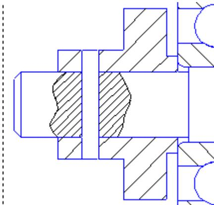
10. Второй вариант рассмотрим на примере построения местного разреза крепления конического зубчатого колеса с валом посредством шпонки.
