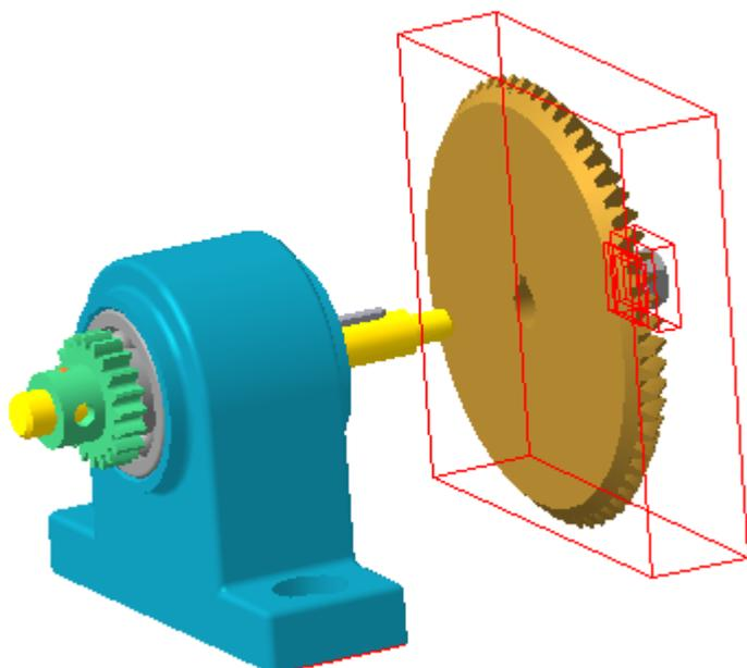
3. Добавьте следующий шаг, и так далее. Для штифтов укажите направление выноса вдоль оси штифта, т.е. вертикально направленное ребро основания корпуса относительно отверстия в ступице закрепляемой детали. В итоге получим:
