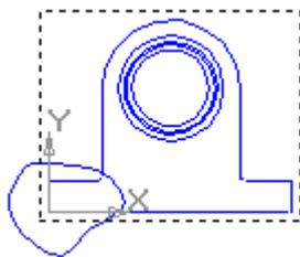
10. Выберите на Инструментальной панели **Ассоциативные виды** команду **Местный разрез**. Сначала укажите замкнутую кривую, ограничивающую разрез, затем задайте положение секущей плоскости на главном изображении на оси симметрии:
