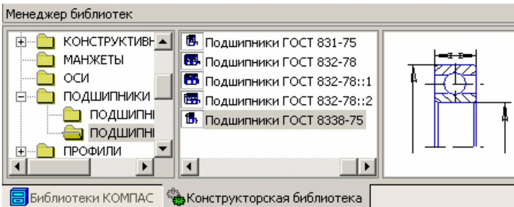
3. Выберите параметры подшипника по посадочному диаметру вала: внутренний диаметр  $d$  и внешний –  $D$ . Нажмите **ОК**.
