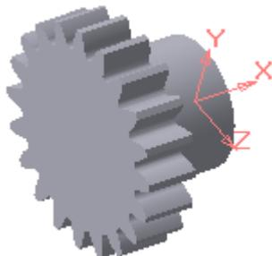
14. Добавьте на торцевой плоскости диска зубчатого колеса цилиндрический выступ. Для этого, выберите команду **Внешняя цилиндрическая ступень**, укажите данную торцевую плоскость, задайте необходимые параметры и завершите построение.
