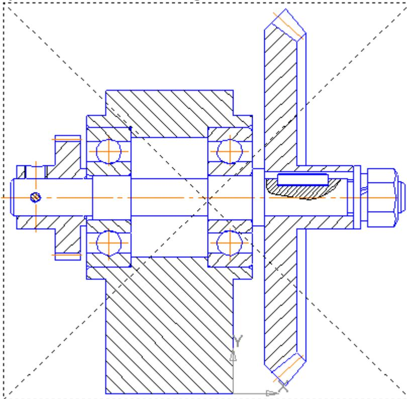
14. На сборочном чертеже могут быть проставлены справочные (габаритные), установочные и исполнительные размеры.
